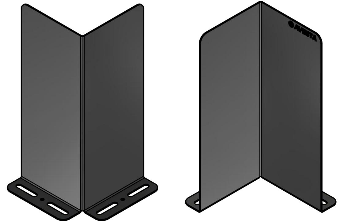
Защитный экран чёрного цвета в виде вертикального уголка, выполненного из анодированного алюминиевого сплава. Удобно устанавливается на оптический стол или плиту с сеткой отверстий М6 или ¼-20. Экран может быть снабжён магнитными держателями (взамен возможности крепления болтами М4), что позволяет использовать его без болтового крепления на металлических поверхностях.
